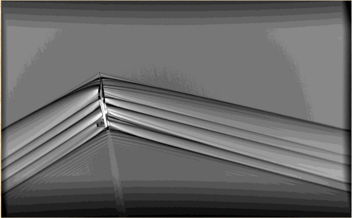
7) Cette image de la NASA montre les fronts d'onde coniques dans l'air générés par le vol supersonique d'un avion.
